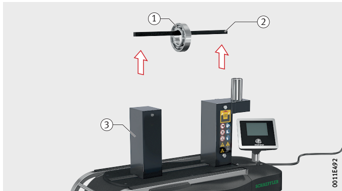
Fig. 48 Verwijderen van hangend wentellager van de oplegbalk
