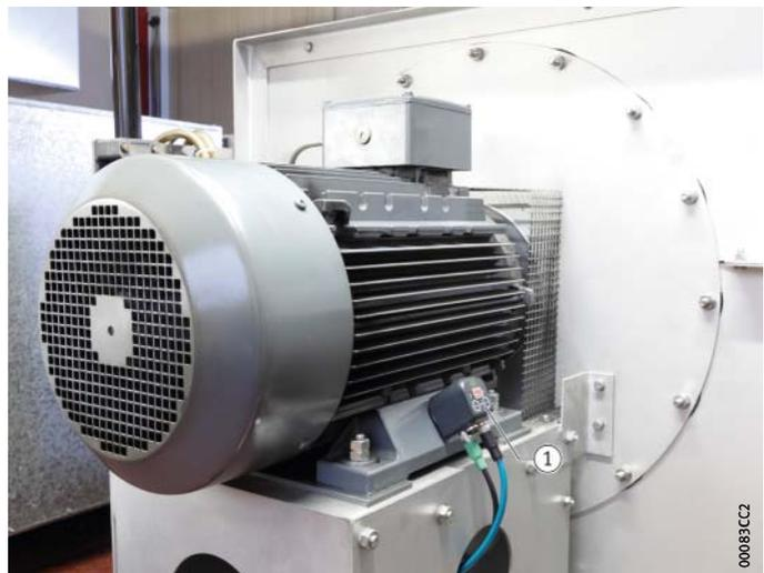
① Positionierung des FAG SmartCheck
