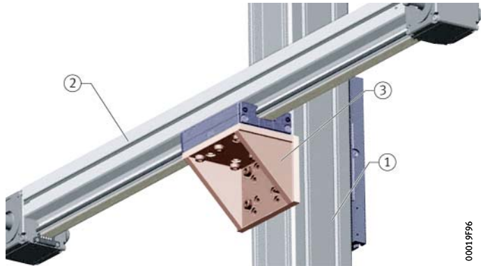
Figure 8 Disposition de montage 5, Correspondance, voir tableau
