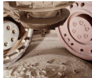
Mahlwalzen in Vertikalmühlen
