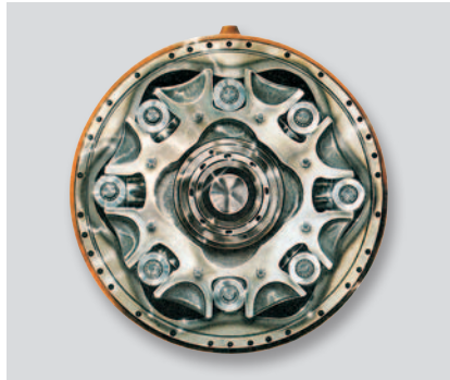
Kammkurven eines Hochmomentmotors
