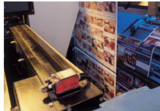
Bahn Betrachtungsgerät, geführt mit Laufrollenführung LFCL
