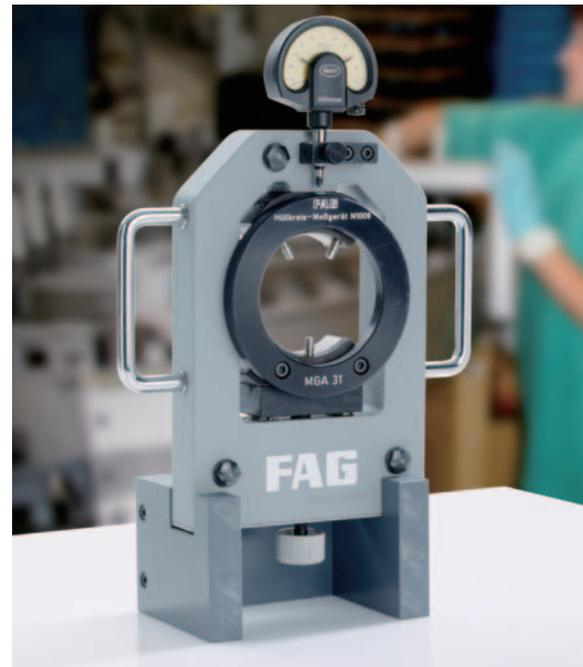
FAG-Hüllkreis-Messgerät zum präzisen Einstellen der Radialluft von Zylinderrollenlagern
