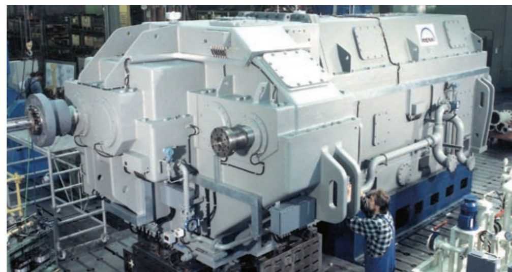
Extrudergetriebe für die Kunststoffindustrie – seit Jahrzehnten mit zuverlässigen INA-Tandemlagern (mehreihige Axial-Zylinderrollenlager) (Foto: Renk)
